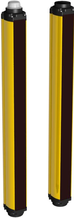
Das SGS Sicherheitssystem mit integriertem Muting von Banner ist eine zweiteilige, redundante, per Mikroprozessor gesteuerte optoelektronische Reflexionsschranke. Standardmodelle sind in 2-strahligen (500 mm Abstand zwischen den Strahlen), 3-strahligen (400 mm Abstand zwischen den Strahlen) oder 4-strahligen (300 mm und 400 mm Abstand zwischen den Strahlen) Systemen erhältlich.
